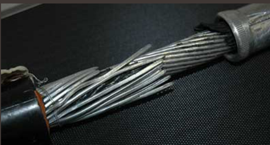
Broken cable conductors
