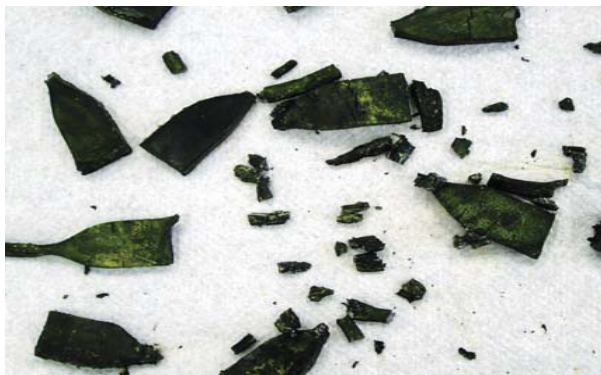
以蜡为主的润滑剂在浸泡试验中显示对低烟无卤素电缆有破坏性
